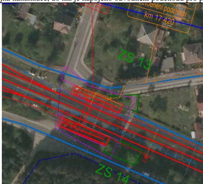
ZS 16 – ZS pro mostní objekt SO 21-34-01 na jižním okraji Hradce Králové (Pražské Předměstí), vlevo trati Pardubice hl. n. – Liberec, km staničení stavby 19,9, nezpevněná plocha, rozloha 120 m 2 , KN 1889/1, k.ú. Pražské Předměstí Areál ZS se nachází v blízkosti křížené vodoteče ID 10174775 a vodní nádrže.
